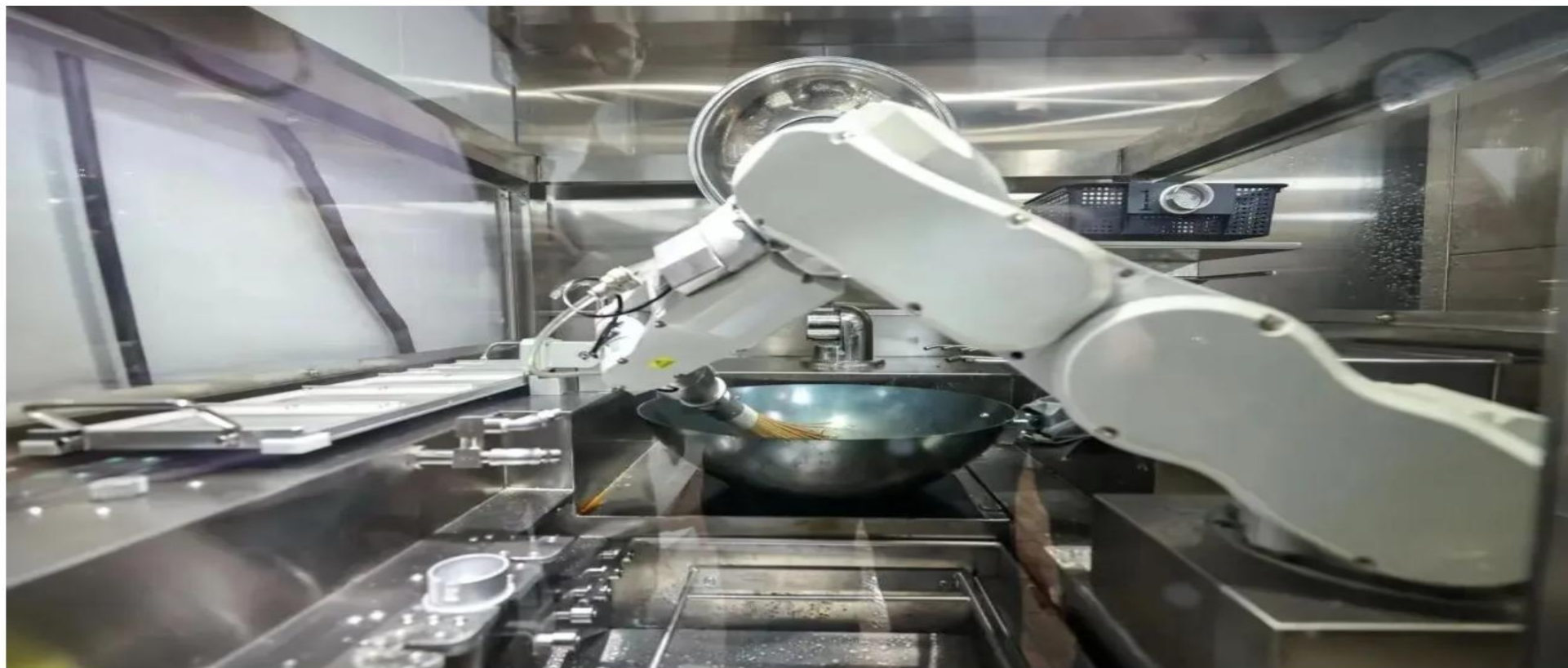
机器人清洗铁锅
